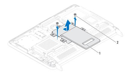
1 Ensamblaje de la base posterior 2 Tornillos (2)
